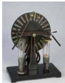
Lehrmittel um 1900: Elektrisiermaschine
